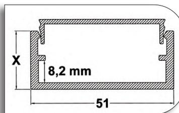
Sirven para tapar los Perfiles en "U" de 40x20 y de 51x21 más la Grapa o Tapeta, que se utilizan para barandillas y otros trabajos.
